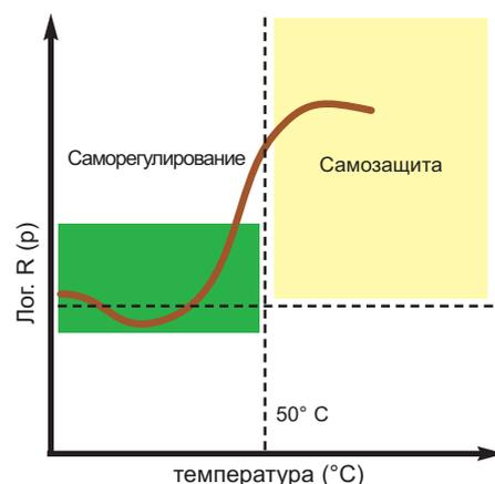
самозащищающийся подогреватель. Греющими элементами в подогревателе топлива РТС являются четыре диска из титаната бария. Их мощность изменяется в зависимости от температуры. Благодаря уникальной зависимости сопротивления РТС от температуры - см. график ниже - он потребляет минимальный ток и не требует дополнительного термостата для регулирования подогрева.
